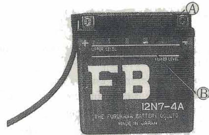
Fig. 54 - Livello batteria
