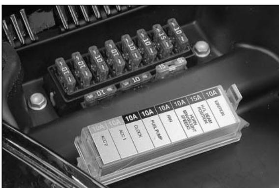
Un fusibile bruciato deve essere sostituito esclusivamente con un altro equivalente. Se anche il nuovo fusibile dovesse bruciarsi una volta montato, rivolgersi assolutamente ad un'officina specializzata KTM.
