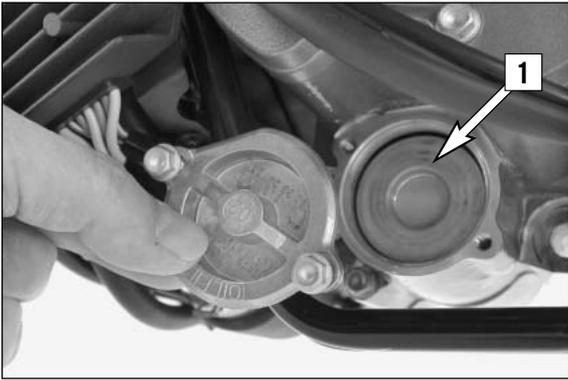
Introdurre un nuovo filtro olio [1] nel carter motore, ingrassare l'O-ring e montare il coperchio del filtro olio completo di O-ring. Serrare le viti a 6 Nm.
