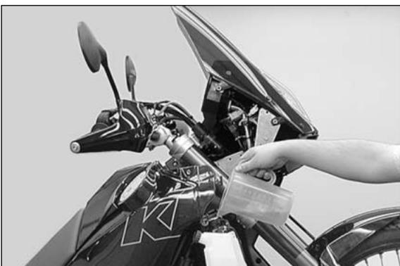
Per poter spurgare completamente il sistema di raffreddamento, è necessario sollevare la parte anteriore della moto di ca. 50 cm.
