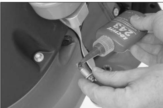
Spalmare Loctite 243 sui filetti delle quattro viti, montare il paramotore e serrarle le viti a 25 Nm.
