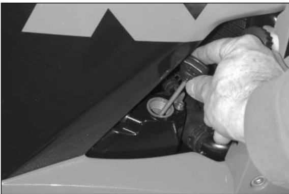
Versare 2,5 litri di olio motore secondo le specifiche JASO MA (p.es. Motorex Power Synt 4T) e montare l'astina livello olio. Avviare il motore, farlo girare per 4 minuti per scaldarlo e spegnerlo. Togliere l'astina livello olio e rabboccare l'olio motore fino alla marcatura MAX (ca. 0,5 litri).
