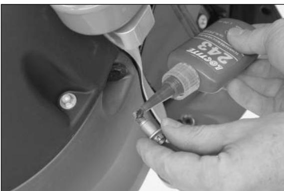
Spalmare Loctite 243 sui filetti delle quattro viti, montare il paramotore e serrare le viti a 25 Nm.
