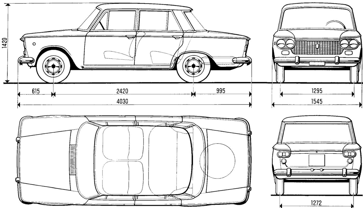
Fig. 9. - Dimensioni principali delle vetture 1300 e 1500.
