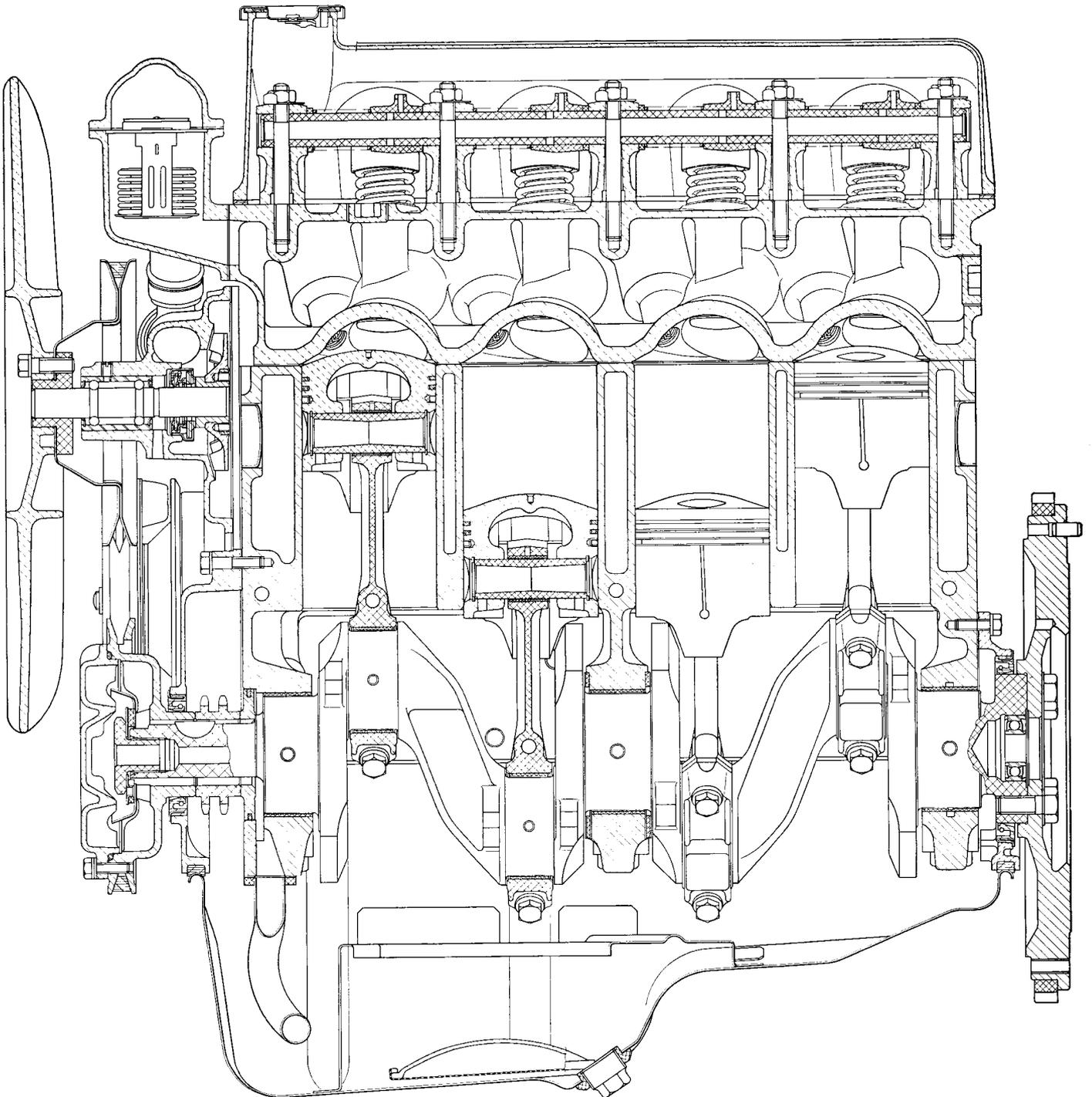
**Fig. 15. - Sezione longitudinale del motore tipo 116, sui cilindri, sugli stantuffi, sulle bielle e sull'albero motore.**
